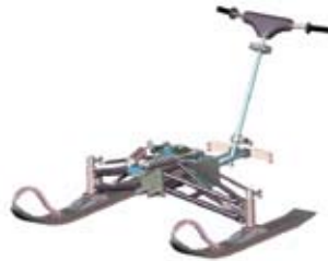
ABBILDUNG 6: DIE FRONTAUFHÄNGUNG EINES MOTORSCHLITTENS BESTEHT AUS ZAHLREICHEN VERBINDUNGEN, EINSCHLIEßLICH FEDERN UND DÄMPFERN.
