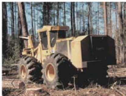
ABBILDUNG 23: DER FÄLLKOPF EINER FÄLL-BÜNDEL-MASCHINE DER FIRMA TIGERCAT MIT SITZ IN BRANDFORD, ONTARIO, KANADA, WURDE IN SOLIDWORKS KONSTRUIERT UND IN SOLIDWORKS MOTION UND SOLIDWORKS SIMULATION SIMULIERT.
